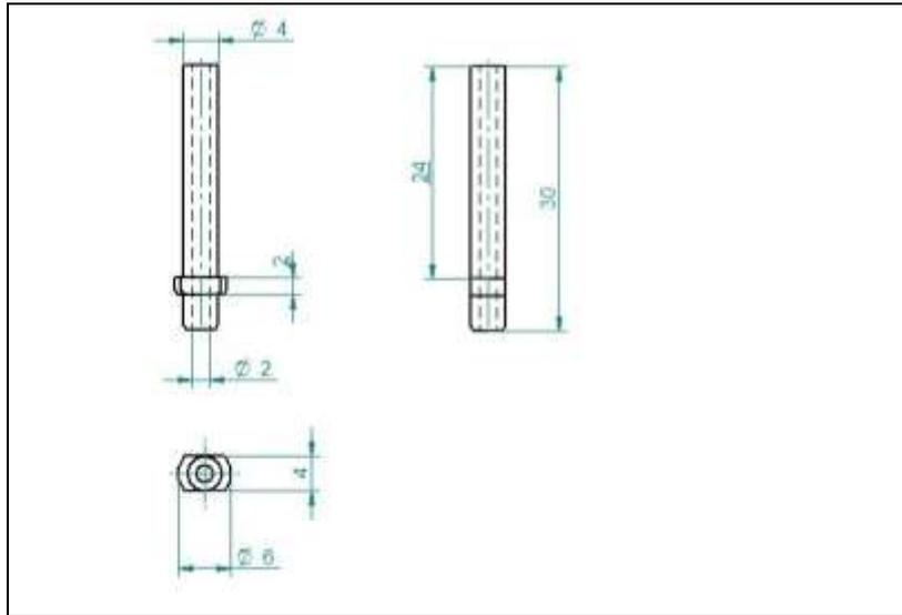
Fig. 19. The gripping spile
