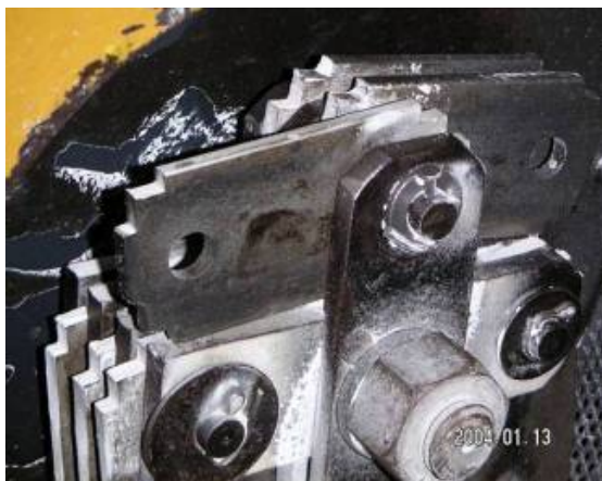
2.1. ábra A kalapácsok elhelyezkedése a daráló munkatérében
