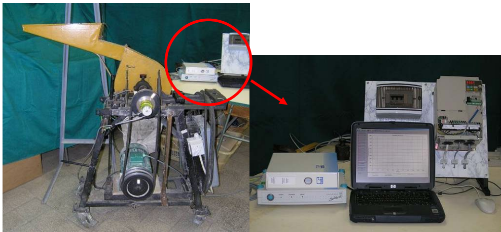
1.2. ábra A Zenit Junior kalapácsos daráló felműszerezve SPIDER 8 mérő-adatgyűjtő, Mérő számítógép, Frekvenciaváltó
