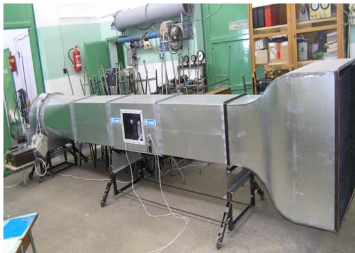
3.2. ábra Szélcsatorna a SZIE-GÉK tanműhelyében (műszaki tervező: Szlivka Ferenc – Balló Béla) (forrás. saját kép)
