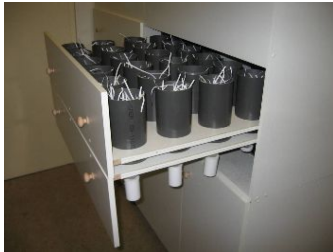
9. ábra: Módosított Tullgren futtató. MTA Talajtani és Agrokémiai Kutatóintézet (Fotó: Simon Barbara)
