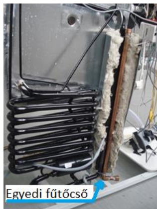
6. ábra Abszorpciós hűtő összekapcsolása a kollektor körrel
