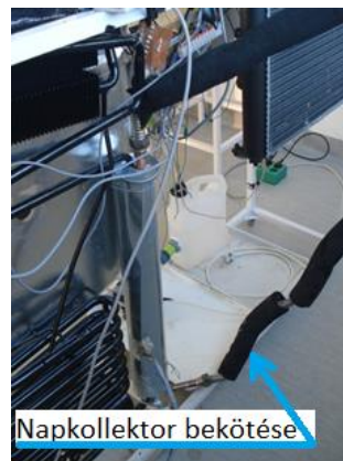
6. ábra Abszorpciós hűtő összekapcsolása a kollektor körrel
