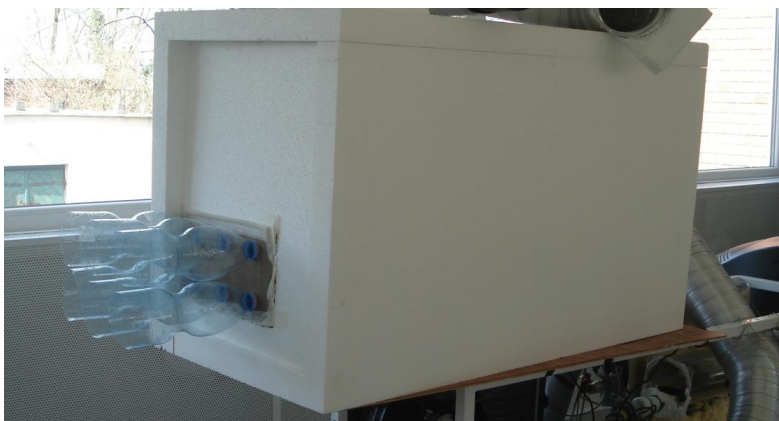
4. ábra Palackos kísérleti alternatív hűtő
